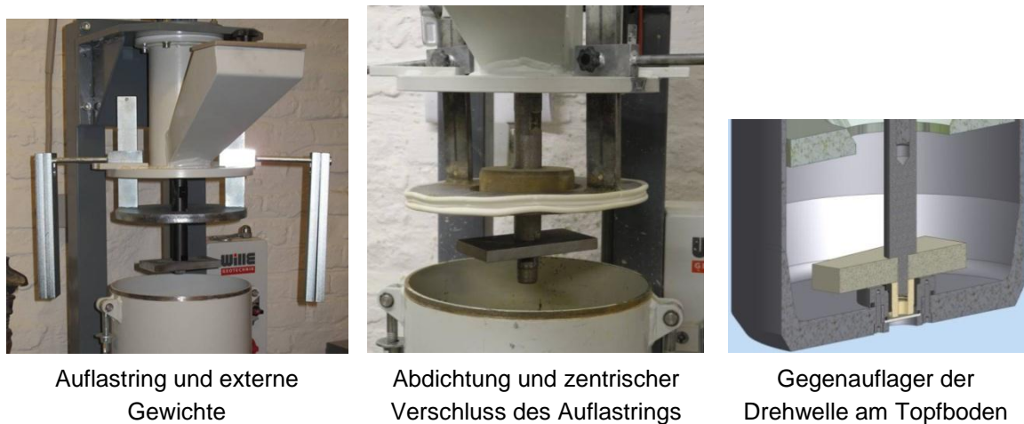
Abb. 2: Entwicklungsschritte des TU Wien – Abrasimeters: wesentliche Adaptionen
