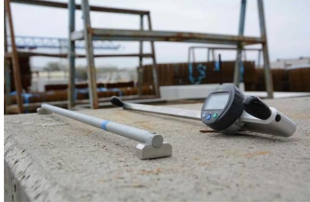
Abbildung 7 : a) Installierte Monitoringeinrichtung in Gars am Kamp. b) Setzdehnungsmesser mit einer Messlänge von 500 mm und Invarstab
