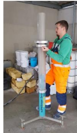
Abbildung 2.4.4: Ergebnisvergleich der untersuchten Betonvarianten im Sliding Pipe Rheometer „Sliper“ und Test set up.
