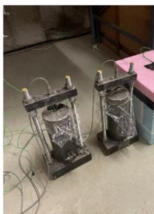
Abbildung 2.4.9: Schwindmessungen: Set-Up und Ergebnisse des Trocknungsschwindens
