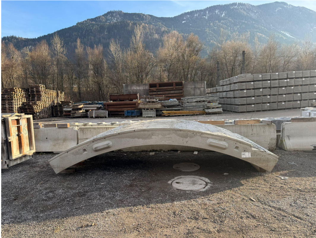
Abbildung 2.5.5: Erster ausgeschalter Basaltbetontübbing.
