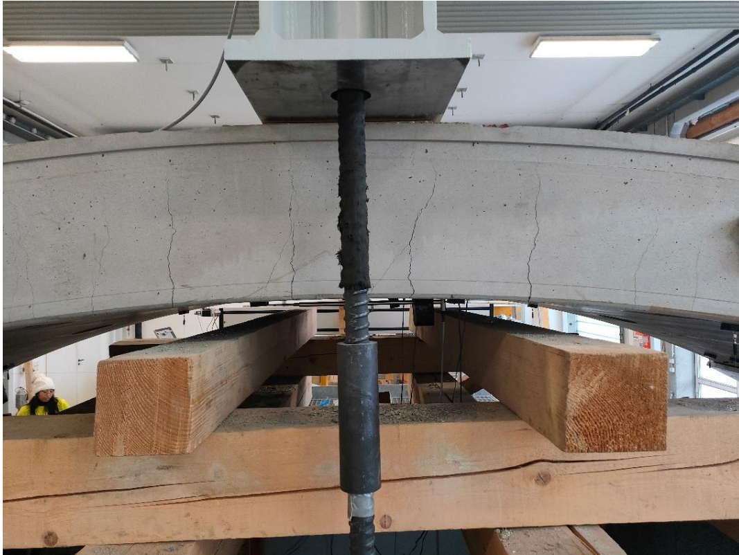
Abbildung 2.6.8: Gleichmäßiges Rissbild eines Basaltbetontübbings, ähnlich jenem der Stahlbetontübbinge; Rissabstände in Abhängigkeit der Position der Bügelbewehrung
