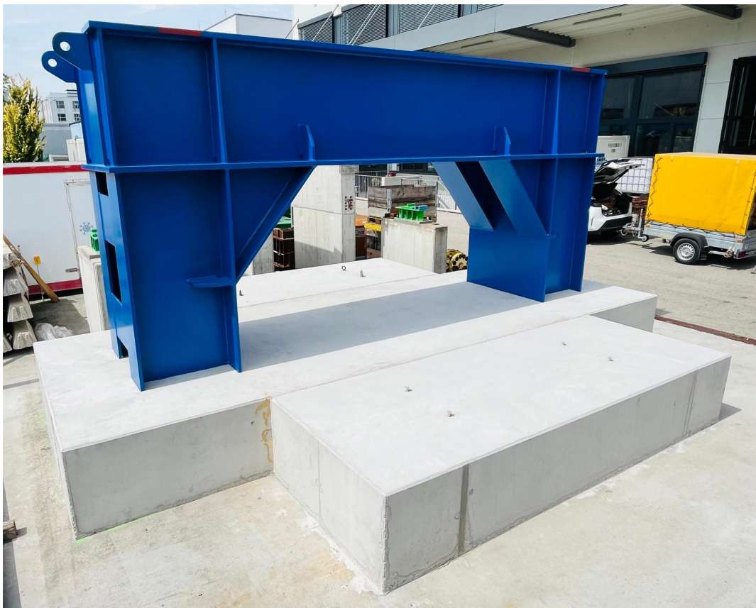
Abbildung 2.3.4: Hergestellter Versuchsrahmen mit Fundamentkörper
