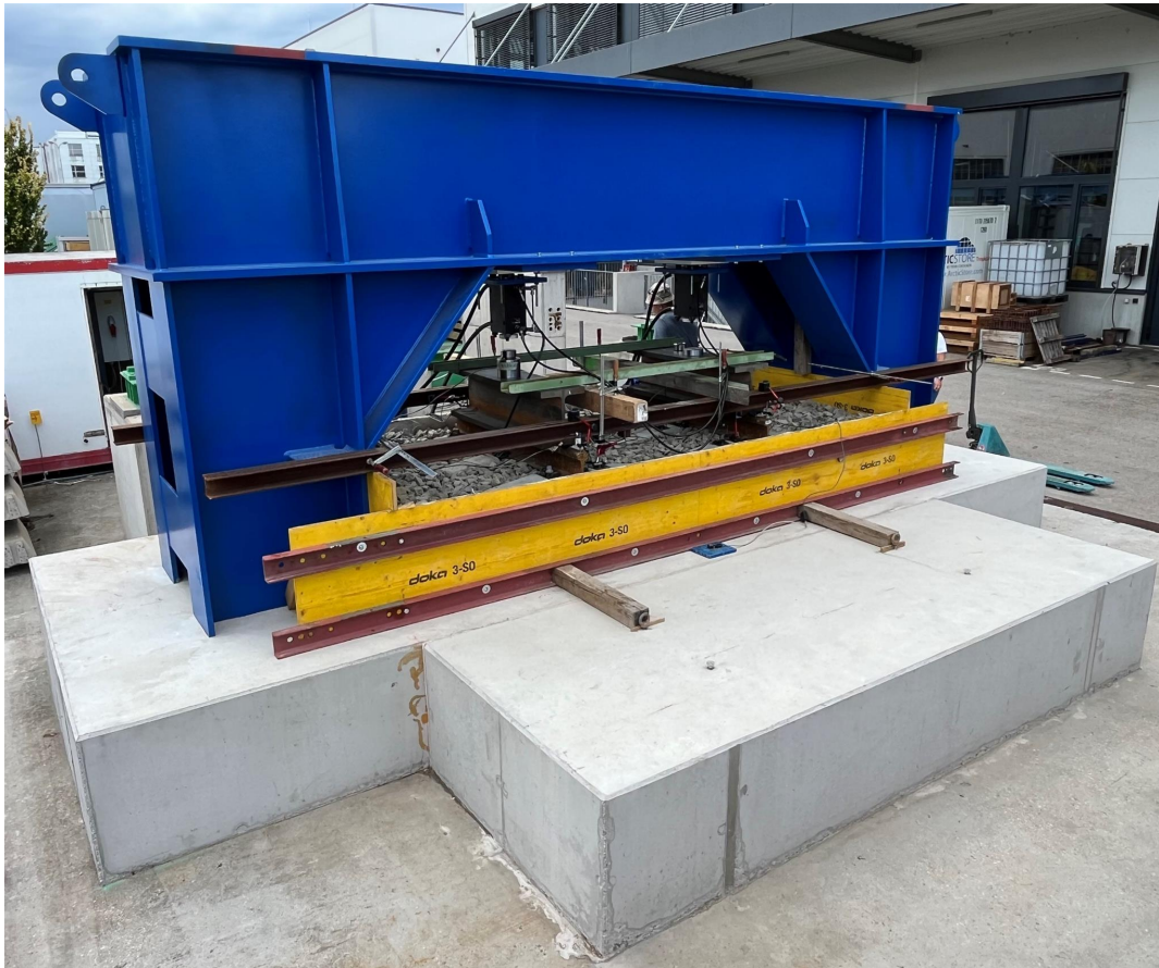
Abbildung 2.4.5: Finaler Versuchsaufbau mit Messsensoren
