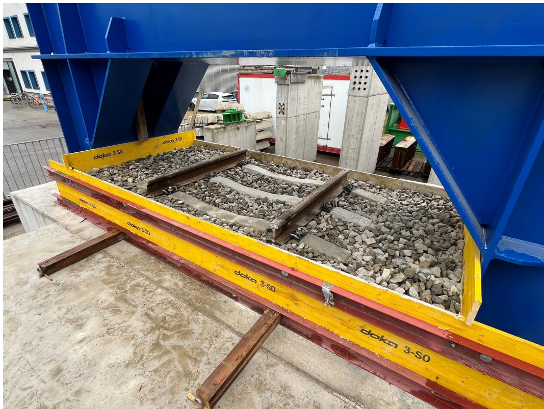
Abbildung 2.4.4: Versuchsanlage mit eingebautem Abschnitt Oberbau
