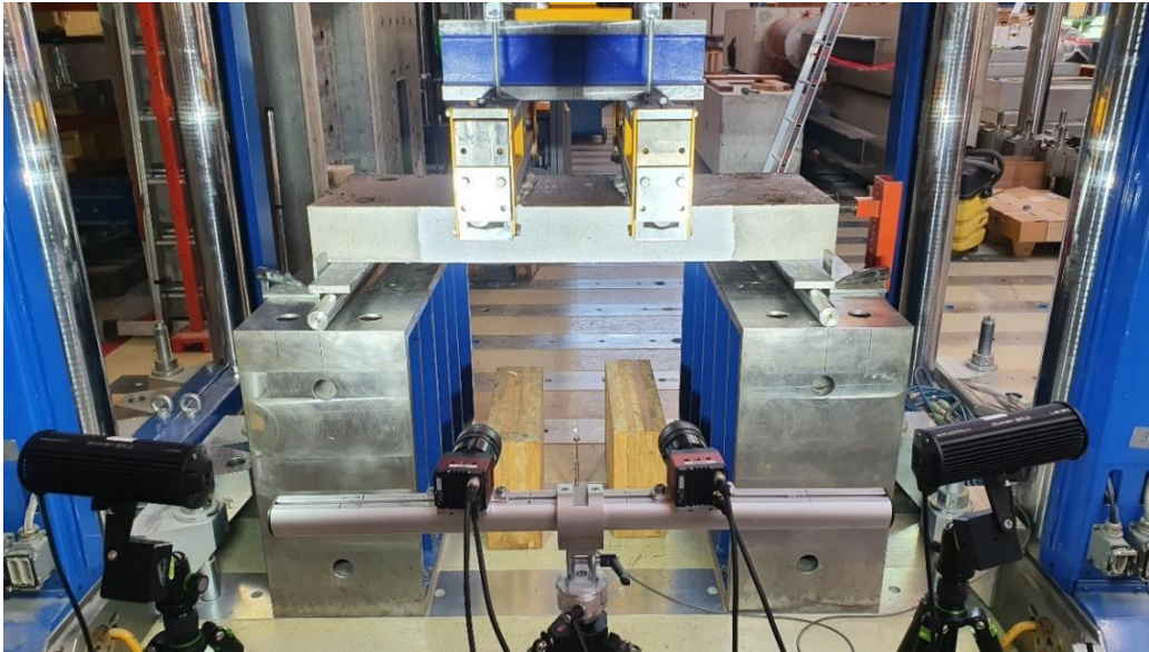
Abbildung 4: 4-Punkt Biegeversuch mit DIC zur Risserfassung
