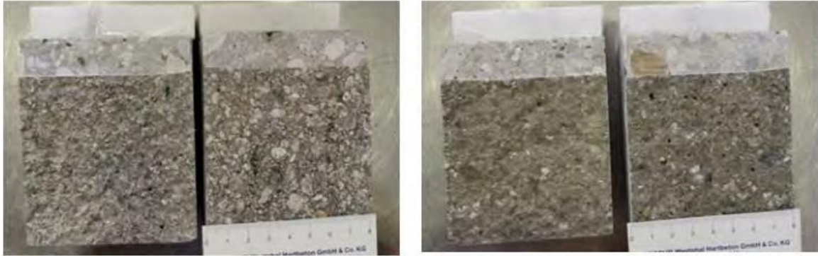
Abb. 13: Bruchfläche eines Probekörpers mit Epoxidharz-Haftbrücke (links) und eines mit zement- gebundener Haftbrücke (rechts)
