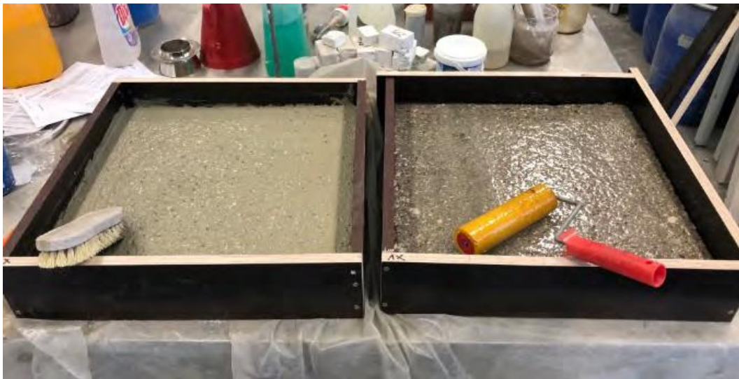
Abb.5: Auftragung der Haftbrücken (zementgebundene Haftbrücke links, Epoxidharz-Haftbrücke rechts)
