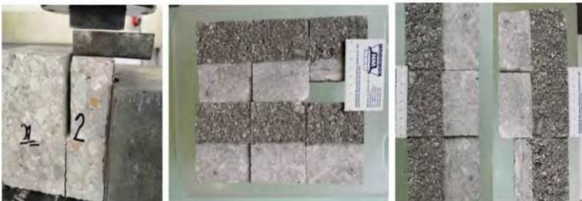
Abb. 11: Rissbildung in der Verbundfuge und Bruchflächen
