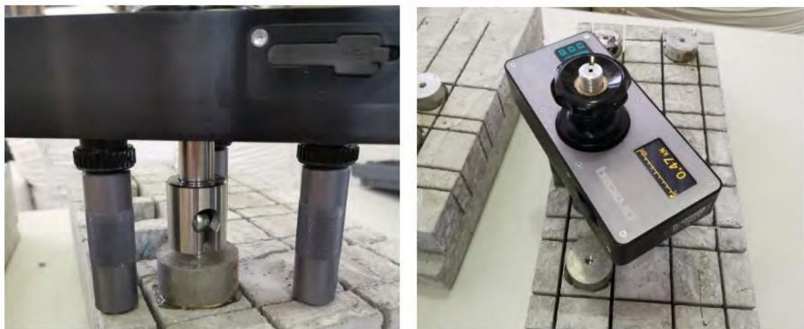
Abb.6: Versuchsdurchführung mit einem automatischen Haftzugprüfgerät
