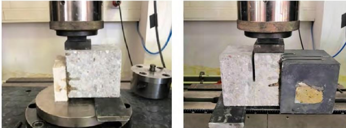
Abb.7: Durchführung des Scherversuches
