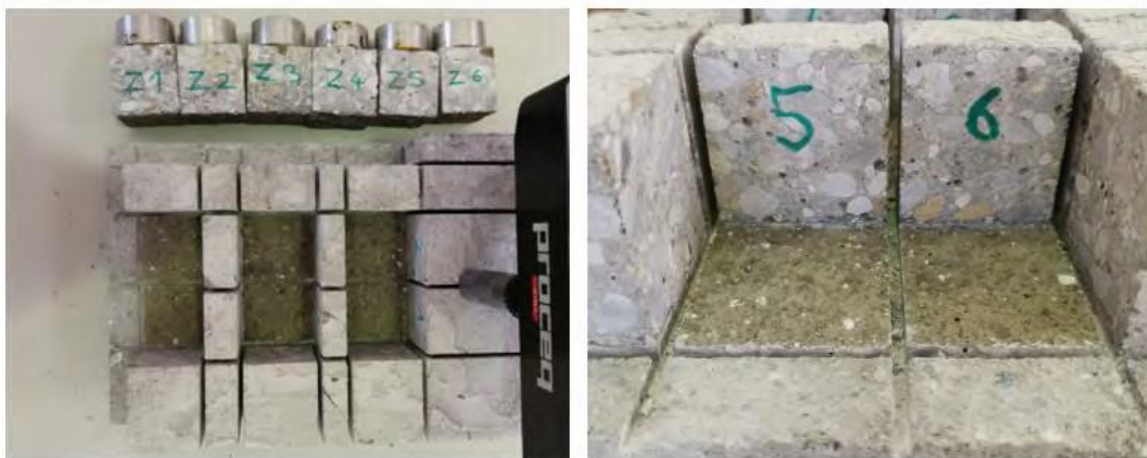
Abb 10: Weitere Bruchflächen Probekörper P42 (Adhäsionsversagen)
