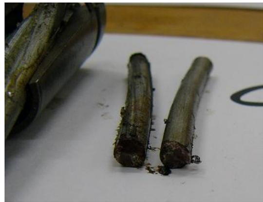
**Abb.3: Ermüdungsbruch eines Drahtes am Verankerungskeil**
