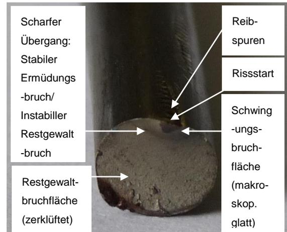
Abb. 14: Makroskopische Charakterisierung einer Litze der Ermüdungsbruchfläche innerhalb der KIZ
