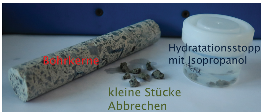
Abbildung 29: Porositätsbestimmung mit MIP
