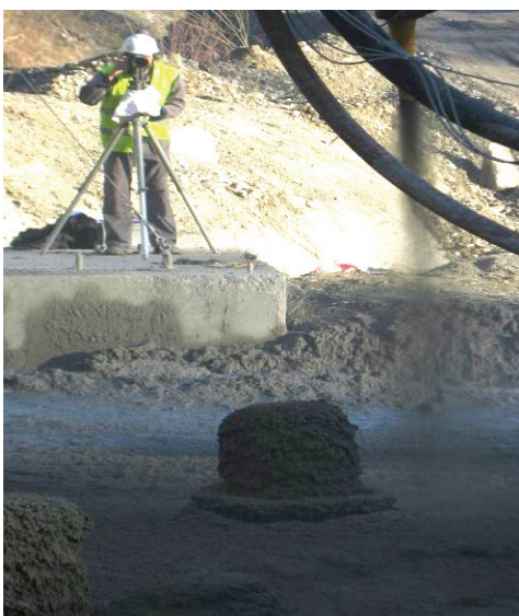
Abbildung 17: Filmen des Spritzstrahls mit Hochgeschwindigkeitskamera (1000 frames per second)
