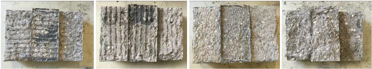
Abbildung 17: Verbundwerte Serien 1, 2 (oben links), Verbundwerte Serie 3 (oben rechts) und Bruchbilder Serie 2 (Rechen quer/längs, Besenstrich, wassergestrahlt)
