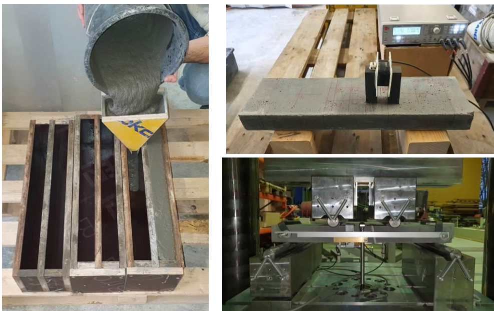
Abbildung 1: Herstellung der Probekörper, Bestimmung der Faserorientierung und Prüfung des
