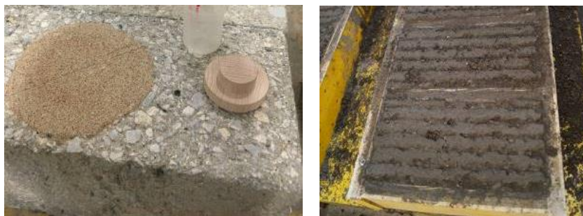
Abbildung 15: Rauigkeitsmessung mittels Sandflächenverfahren (links) und mechanische Aufrauung mittel Rechen (rechts)
