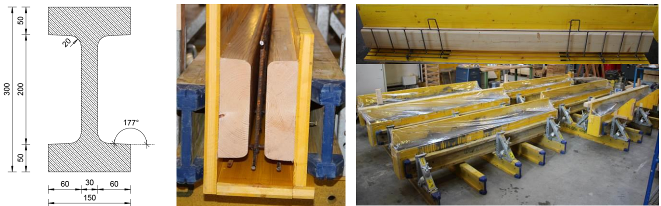
Abbildung 5: Versuchskörperabmessungen (links) und Probekörpererstellung (rechts).
