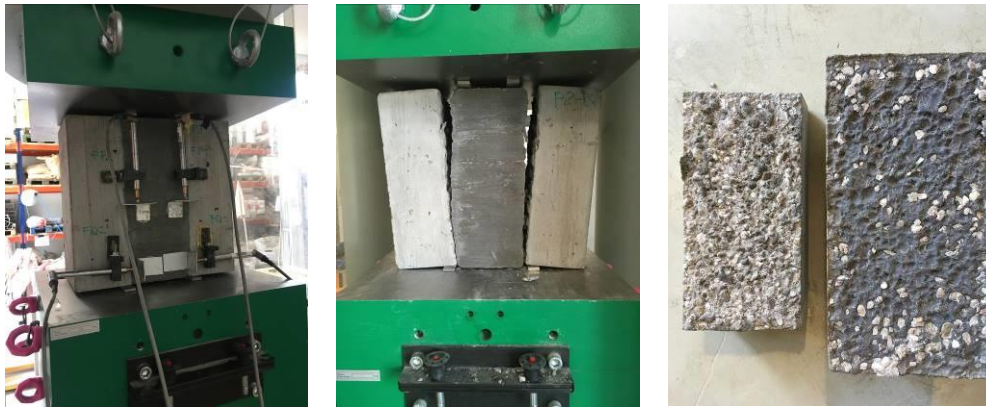
Abbildung 16: Test-Setup für Push-Out Tests (links), Push-Out Probekörper Bruch (mitte), Bruchbild der Serie 1 (rechts)
