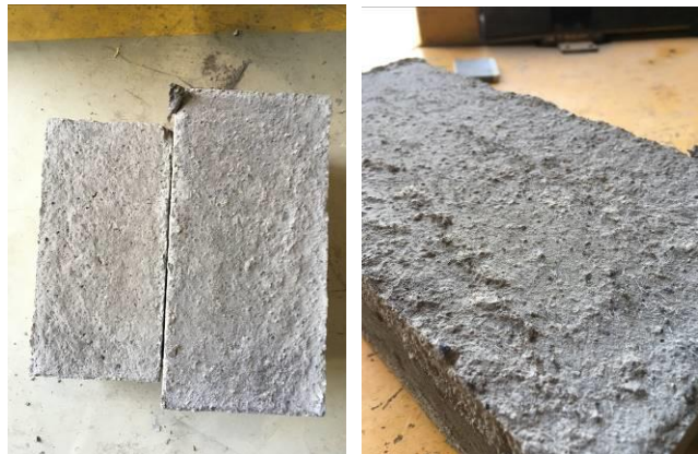
Abbildung 18: Fugenschubspannung (links) und Bruchbild der Serie 4 (rechts)
