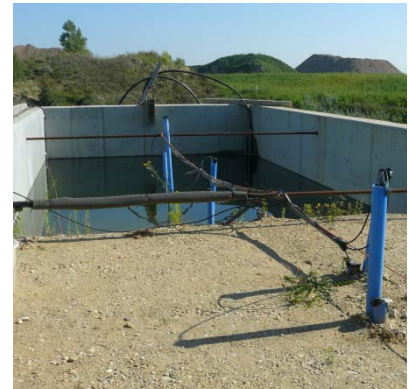
Abbildung 2: Schematische Darstellung des naturmaßstäblichen Dammodells (links). Einstau während der Modellversuche (rechts).
